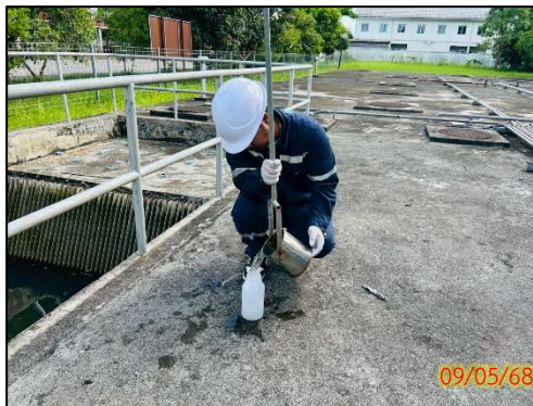
บ่อฟักน้ำเสียก่อนเข้าสู่ระบบบำบัดน้ำเสีย
